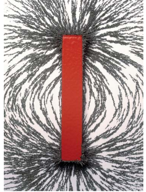
Demir talaşlar manyetik alanın kutuplarda en güçlü olduğunu gösteriyorlar.
