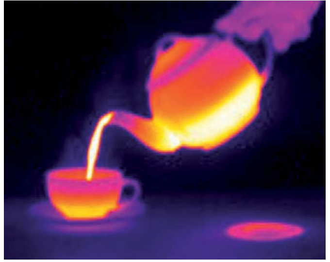
Termal kamera ile çekilen fotoğrafta hangi cisimlerin daha büyük iç enerjiye sahip oldukları görünür.
