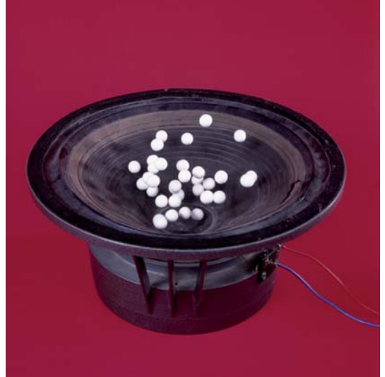
Hoparlörün koni şeklindeki zarı titreşiyor.
